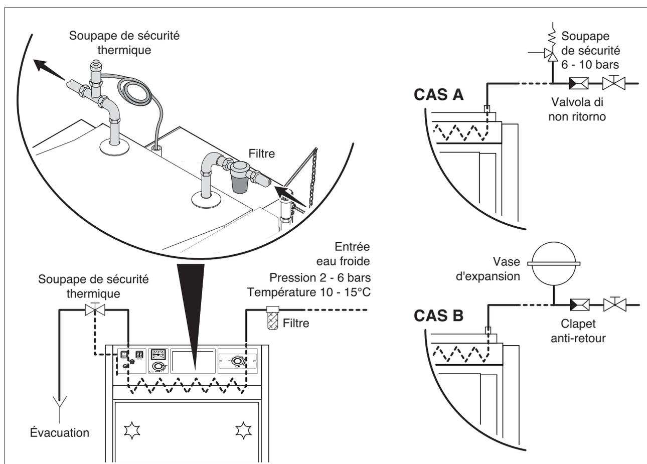
Le capteur de la soupape de sécurité thermique est placé à l'arrière de la chaudière et prévient les surchauffes en agissant comme suit : si la température de chaudière dépasse 95°C, la soupape s'ouvre et permet à l'eau du réseau d'entrer dans l'échangeur. Cette eau absorbe ainsi l'énergie en excès et sort à l'évacuation.
