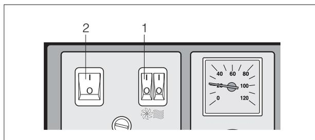
La puissance du brûleur doit être réglée en fonction du besoin de l'installation de manière à éviter la formation de condensats dans la cheminée. Régler une puissance d'au moins 10 kW (voir la notice d'instructions du brûleur à granulés de bois).
