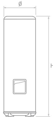
Les préparateurs Pianeta sont des accumulateurs d'eau chaude sanitaire à chauffe rapide. Afin d'obtenir les meilleurs résultats sur la stratification de l'eau, la taille et le positionnement de l'échangeur ont été optimisés.
